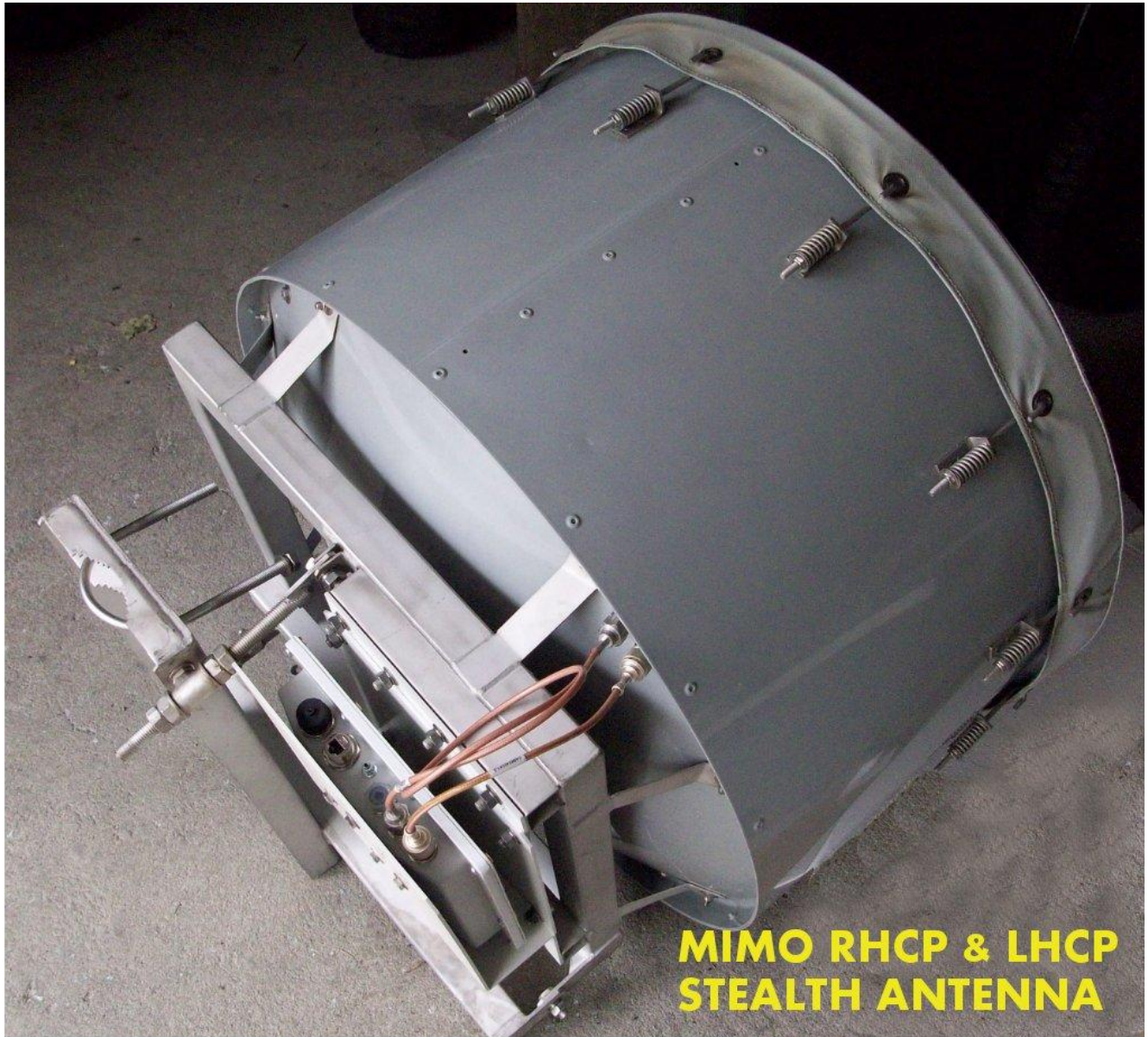
Vue par dessous de l'Antenne furtive de 72 cm avec source Dual Advanced MIMO support Radio et capot Blindé
