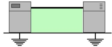
⇒ *Conseils* : pour éviter la présence d'inductances parasites dans les circuits, on applique un certain nombre de règles de câblage : liaisons les plus courtes possibles, câblage à angles droit, boucles de surfaces minimales, séparation entre les circuits de puissance et les circuits sensibles.
