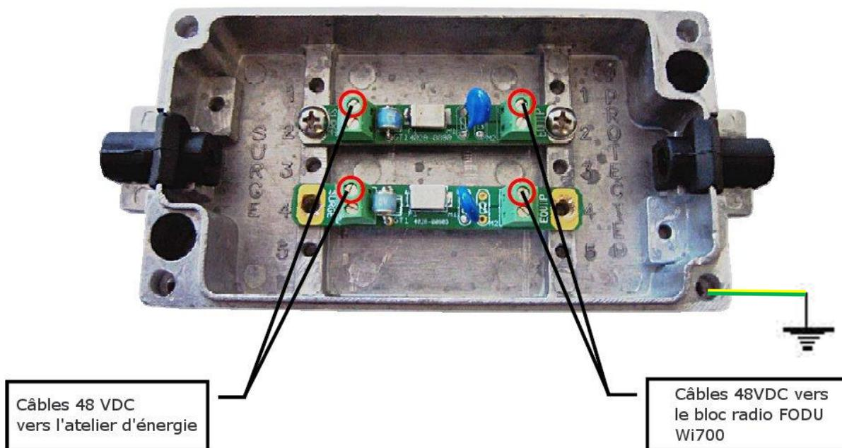
*Protection para-surtension du câble alimentation 48 VDC vers le Cordon Moulé câblage a vis ou a sertir pour Wi700 48 VDC, 0.3m, IP68 p/n IOACGE04*
