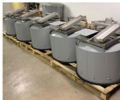
Assemblage final des antennes Furtives Blindées Dual-Helix
