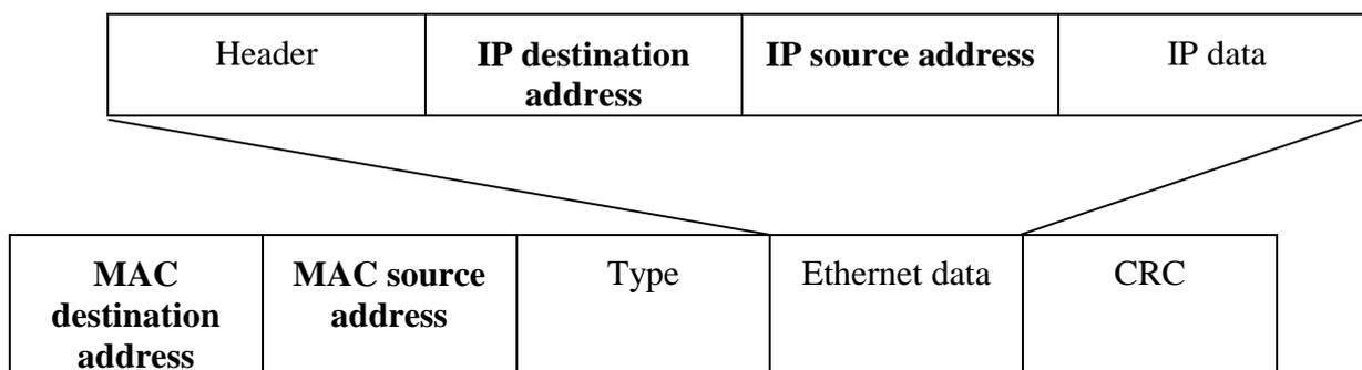
Fig. 3.2 Ethernet frame
