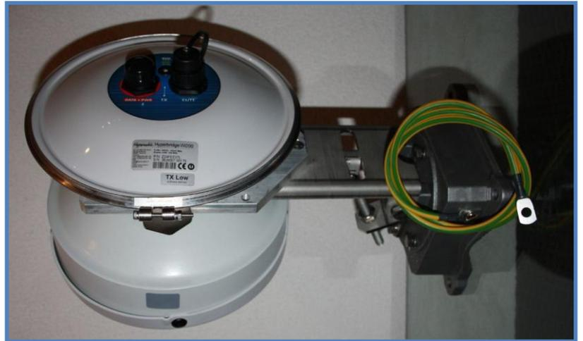
Vue ¾ arrière du Bloc radio fixé à l'antenne
